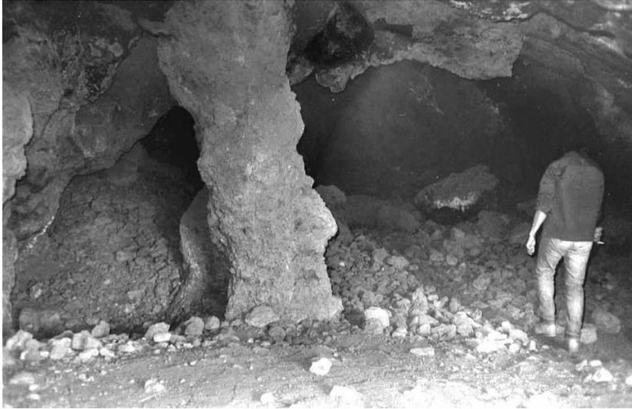
*Figura 2.1.* Este pilar es uno de los muchos que sostienen los techos de cámaras aún en pie. Al remover estos apoyos ocurre el derrumbe de las cámaras, lo que a su vez produjo las depresiones.
