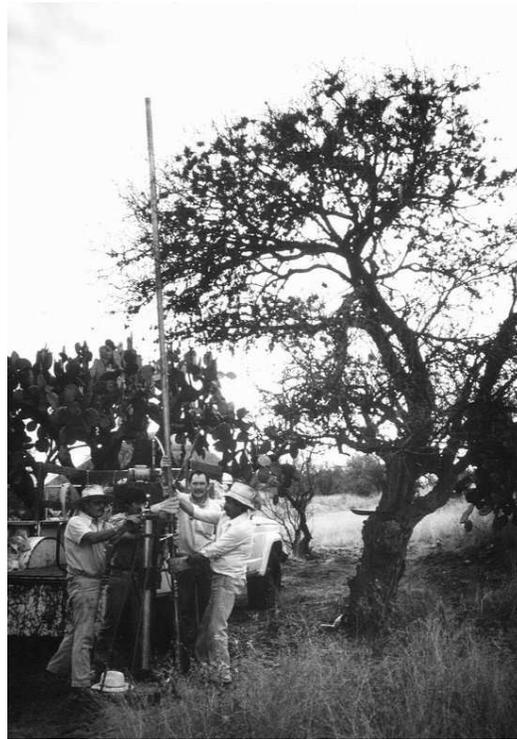
*Figura 1.9.* Equipo de perforación empleado; el diámetro interior de la broca es de 7 cm, llega hasta 9 m de profundidad al unir tramos roscados de 45 cm.
