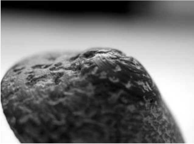
Figura 100. Algunos de los discos de basalto presentaron residuos de una resina adhesiva, probablemente chapopote.
