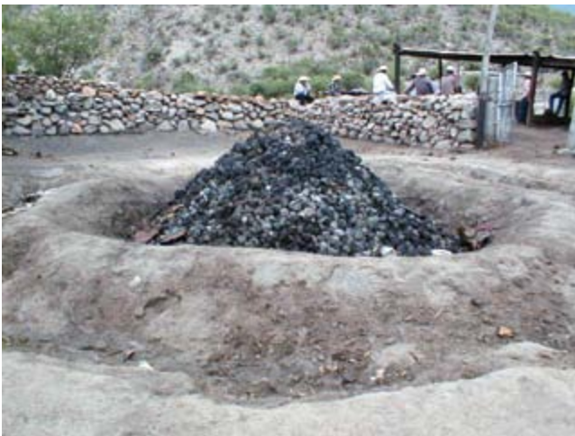
Figura 67. En la comunidad de El Venado en el municipio de Nombre de Dios, Durango, todavía es posible encontrar productores de mezcal que utilizan hornos hechos con paredes de tierra.
