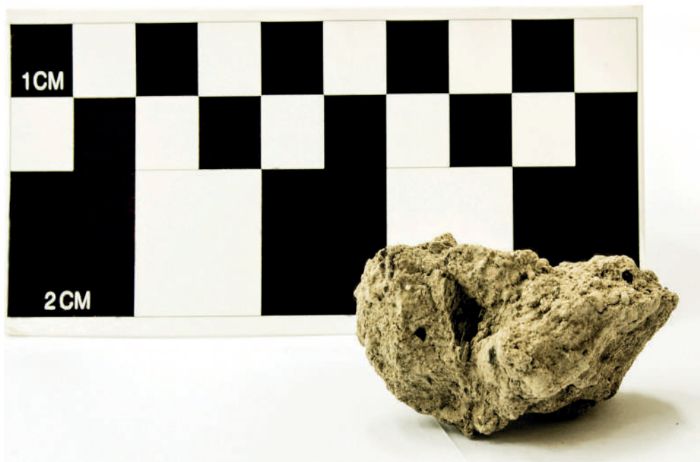
Figura 6. Adobe donde se observan fragmentos de carbón (fotografía I. Rangel).
