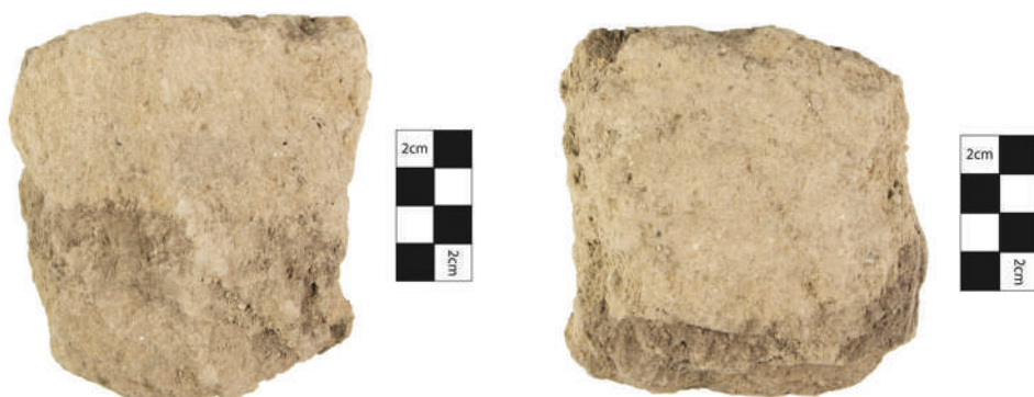
Figura 2. Fragmentos de adobe donde se observa la diferencia de color y textura (I. Rangel).
