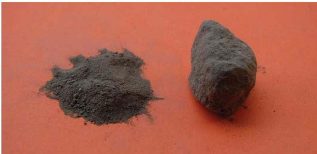
*Figura 36.* Junta de los adobes en donde se observa la dureza, consistencia y ausencia de poros, y una pequeña muestra de junta triturada en donde se nota el alto contenido de arena (abajo).
