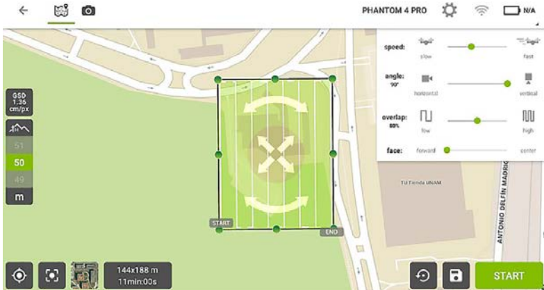
Figura 36. Parámetros para automatización del vuelo de un dron en Pix4d capture.
