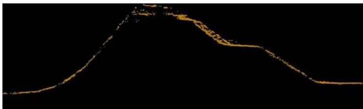
Figura 43. Perfil de nube de puntos LiDAR filtrada.
