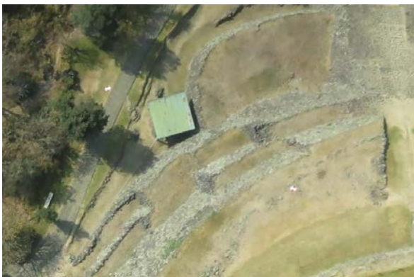
Figura 35. Puntos de control terrestre para el levantamiento de la pirámide de Cuicuilco.
